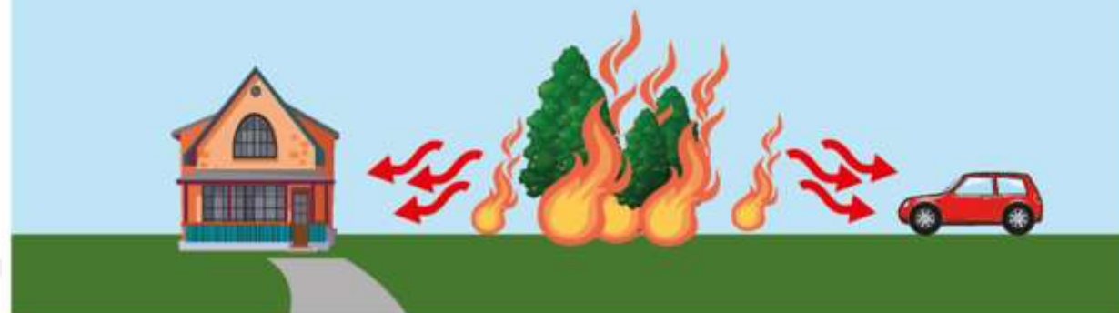
Propagazione incendio per irraggiamento
