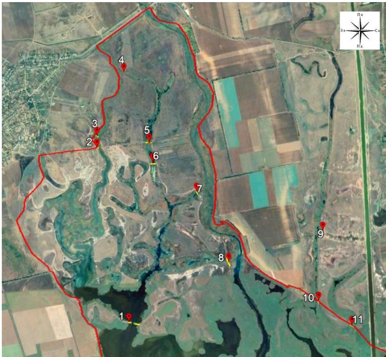
Fig. 34 Mappa che mostra le posizioni delle dighe che sono state rimosse (nn. 2-11). La breccia nella diga n. 1 è stata allargata durante il progetto. Le brevi linee gialle indicano la posizione degli argini di argilla. La linea rossa è il confine della Riserva della Biosfera del Danubio.
